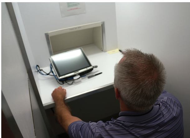
NASAs sensoriske avlukke brukes til å teste matmaker. Maten går gjennom sporet til testerne og resultatene er registrert på datamaskinen.
