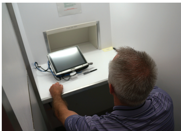
Ett NASA-sensorbås används för att testa livsmedelssmaker. Maten distribueras via luckan till provsmakaren och resultaten upphämtas på datorn.
